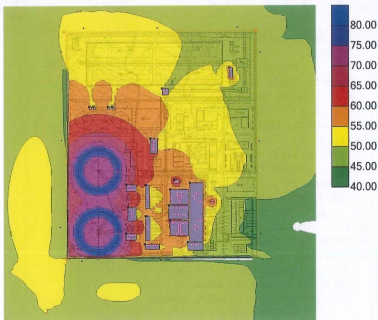
(1) 热电二期工程噪声贡献值等声级曲线预测图 (预测高度 1.2m)
